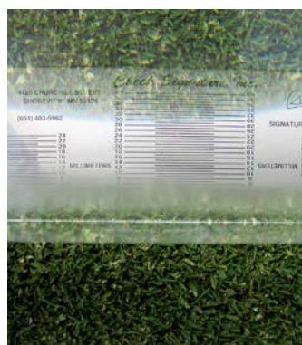
Schnitthöhenmessung mit dem Prisma
